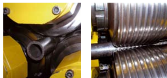
Przykład obróbki rury Gwint stożkowy 1/4" do 2 3/4" NPT
