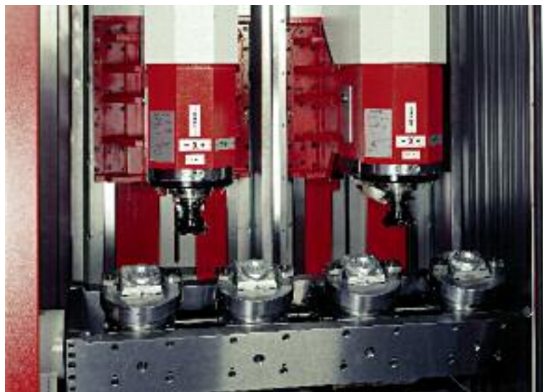
Rechter Arbeitsraum mit Schwenkbrücke und Vorrichtung
