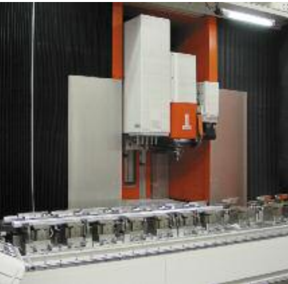
matec-30 L mit Sonderspannvorrichtungen für Aluminiumprofile
