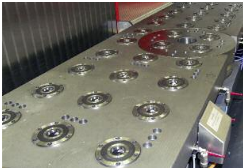
Maschinenbett mit integriertem Rundtisch und eingesetztem Nullpunktspannsystem
