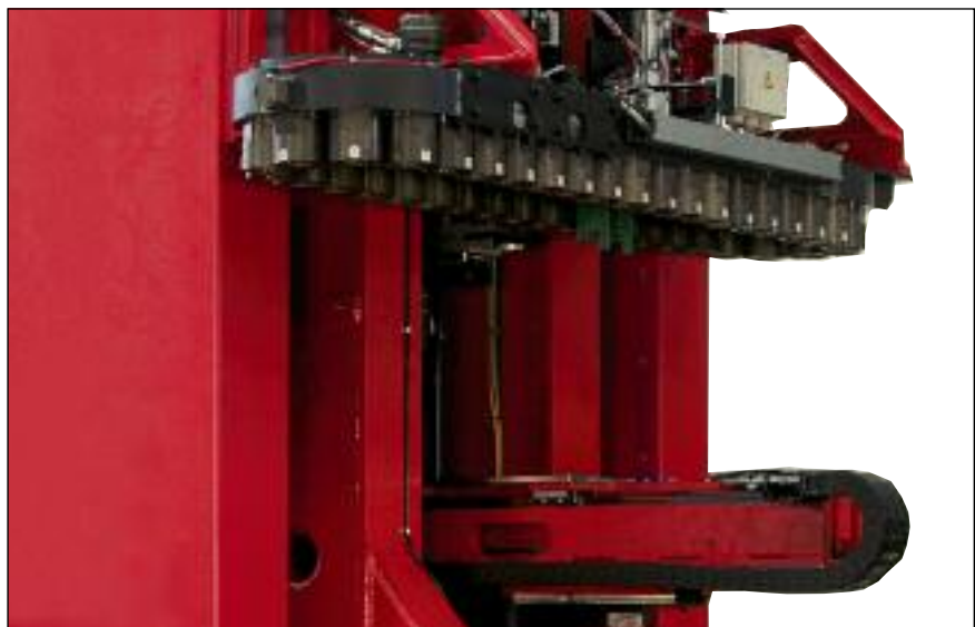
Werkzeugmagazin mitfahrend für 40 oder 60 Werkzeuge
