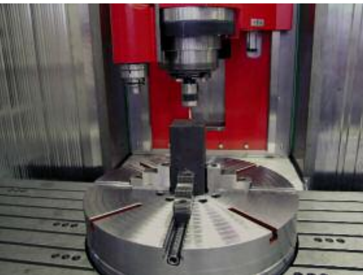
Arbeitsraum mit integriertem Rundtisch und aufgesetztem Backenfutter
